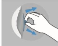
**Remover:** Después de aplicar la primera capa de pintura y esté seco el tablero de yeso alrededor, remueva la lámina protectora transparente halando la pestaña emergente.
