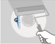
**Pintar:** Pinte inmediatamente con un rodillo para pintar de alta calidad y pintura de látex para interior. Se recomienda pintar presionando ligeramente y aplicando una cantidad copiosa de pintura. **NO SE REQUIERE RESANAR O LIJAR.**
