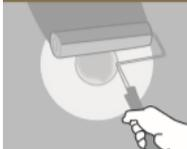
**Terminar:** Aplique dos capas espesas de pintura adicionales para una reparación lisa e invisible. Eclipse de DAP se puede utilizar también para paredes y techos texturizados con el uso de texturas en aerosol o rodillos para pintura texturizada\*
