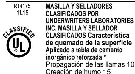
\*PROBADO Y APLICADO EN TRES CORDONES DE 3/4" DE DIÁMETRO, 6" DE CENTRO A CENTRO, CUBRIENDO 12.5% DEL ÁREA DE LA MUESTRA DE PRUEBA EXPUESTA
