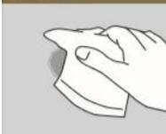
**Preparar:** Empuje los bordes dañados o desiguales hacia el interior de la pared y lije el área dañada y los alrededores del tablero de yeso, utilizando papel de lija. Utilizando un paño seco o mojado, limpie la superficie que se va a reparar para remover cualquier suciedad, polvo y desecho, asegurándose de tener una superficie lisa y libre de polvo. Si utiliza un paño mojado, asegúrese de que toda la superficie está seca antes de aplicar el parche rápido para reparar paredes Eclipse.
