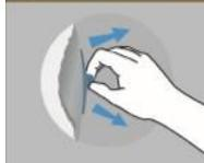
**Remover:** Después de aplicar la primera capa de pintura y esté seco el tablero de yeso alrededor, remueva la lámina protectora transparente halando la pestaña emergente.
